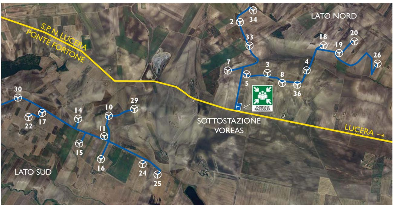
L'impianto con i suoi 24 aerogeneratori, si colloca in un contesto collinare, su quote comprese tra i 300 m ed i 400 m s.l.m. E' costituito da n°24 aerogeneratori REpower mod. MM82, ciascuno di potenza nominale pari a 2 MW, le cui caratteristiche sono riportate nelle successiva Tabella 2.1, per una potenza installata totale pari a 48 MW.
